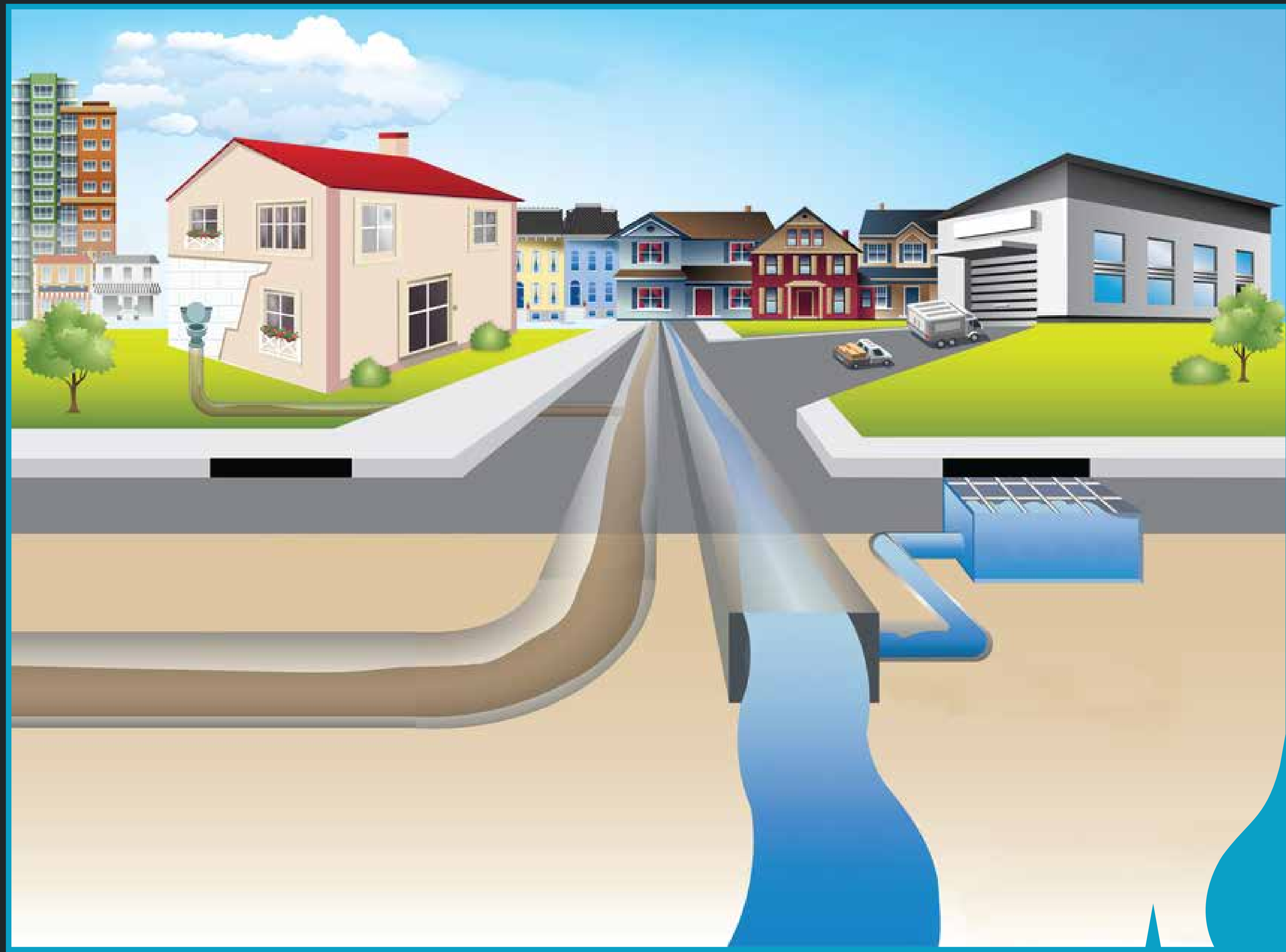
Réseau séparatif Separate sewer system
